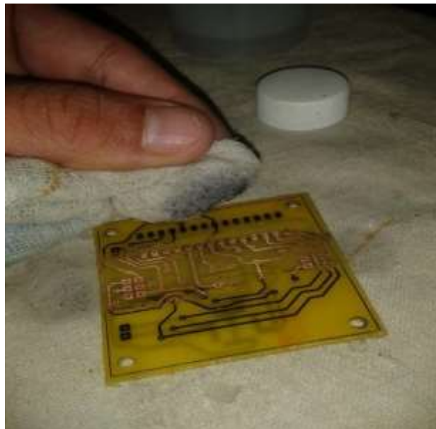
Imagen: Limpieza de placa con un trapo y tiner
