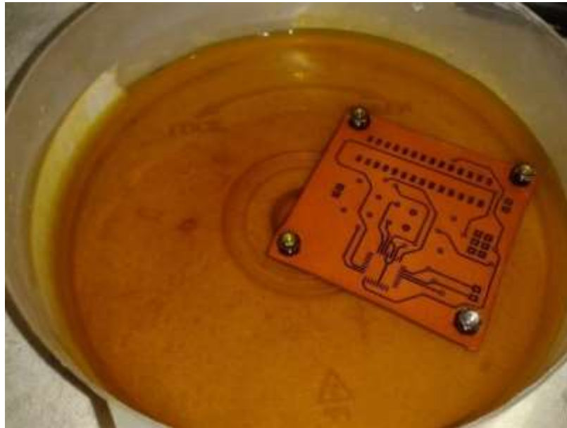
Imagen: Quemado de la placa con cloruro férrico
