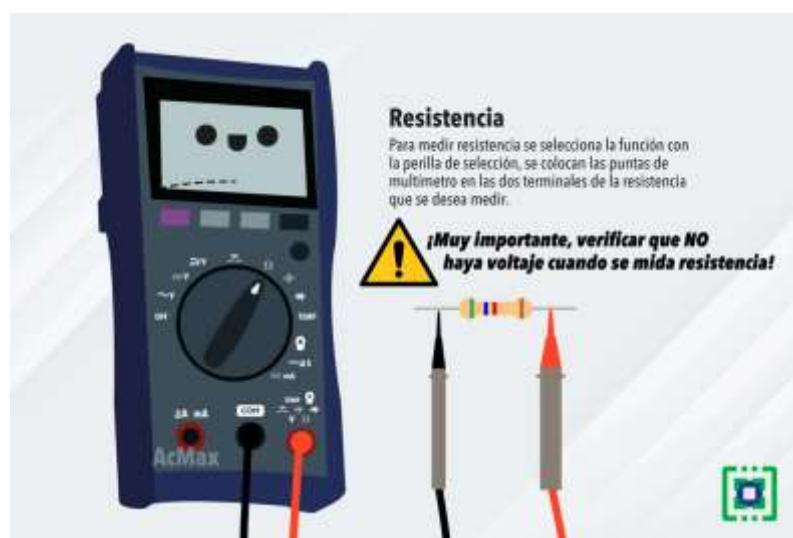
Imagen: medición de Resistencia
