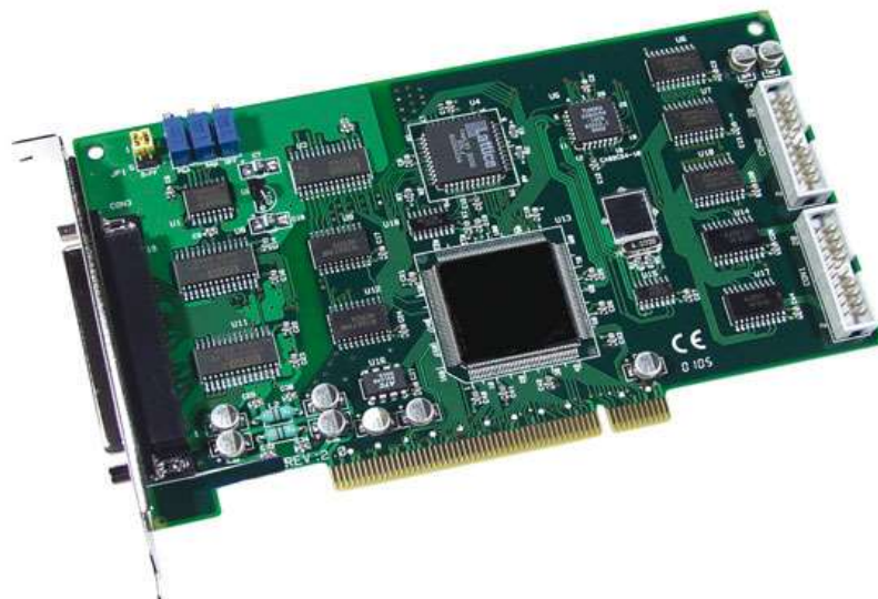
Imagen: Ejemplo de una adquisición de datos en un integrado Fuente: https://es.omega.com/das/images/OME-PCI-1002_1.jpg
