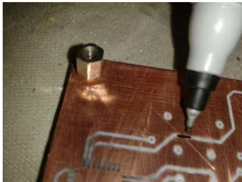
Imagen: Reparación de pistas con marcador de punta fina permanente
