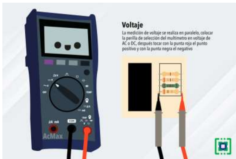
Imagen: medición de Voltaje
