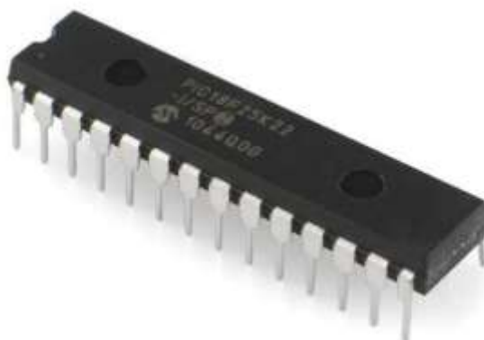
Imagen: Microcontrolador PIC de 28 pines, uno de los muchos modelos existentes
