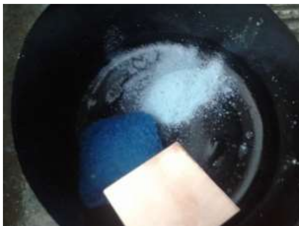
Imagen: Limpieza de la placa de cobre de doble cara
