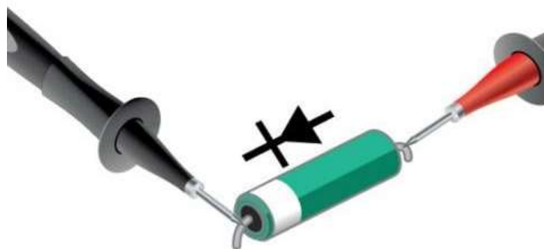
Imagen: Ejemplo de como se mide un diodo con su esquemático y empaquetado
